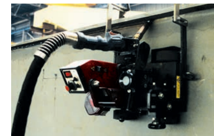
Autonome Fahrwagen mit Akku. MIG/MAG-Schweißen mit manuellem Zubehör.
