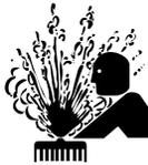
Revise el nivel de anticongelante observando el nivel en el radiador y botella de recuperación. Agregue una solución de 50/50 de anticongelante / agua si el nivel está cerca o por debajo de la marca "BAJO". No llene sobre la marca de "LLENO". Remueva el tapón del radiador y agréguele anticongelante. Llene hasta la parte superior del tubo en el cuello de llenado del radiador que incluye una manguera de conexión que viene desde el alojamiento del termostato.
