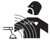
2.b. 电磁场可能会干扰一些心脏起搏器，且拥有起搏器的焊工在焊接前应咨询自己的医师。
