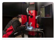
Los estudiantes practican habilidades del mundo real con soldadura multi-pass en accesorios de 6 y 18 pulgadas en los modos Arc ON o Arc OFF.
