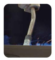
Equipos de soldadura diseñados para producir niveles más bajos de humo de soldadura
