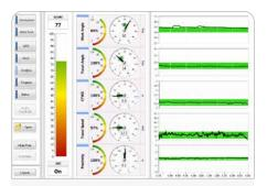
La puntuación del rendimiento de la soldadura en indicadores clave de soldadura adecuada proporciona una evaluación inmediata de cada soldadura.
