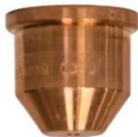
**La boquilla** es el consumible que se reemplaza con más frecuencia. Una de las señales de que se debe reemplazar la boquilla es la acumulación excesiva de escoria y el ángulo de bisel que aparece en los cortes. En la propia boquilla, constatará que un orificio más grande o un agujero de forma irregular serán signos de desgaste excesivo.
