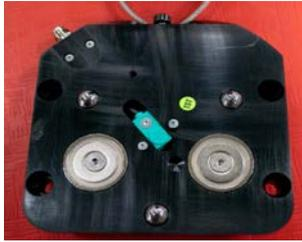
Mueva la máquina a la posición de referencia y separe el soporte de la antorcha tirando de la antorcha desde abajo hacia la izquierda o hacia la derecha. La placa trasera ahora debería estar visible. Utilice un trapo para eliminar los restos metálicos de los dos imanes o las tres muescas de ubicación. Para montar la antorcha, primero alinee los bordes superiores del soporte de la antorcha, recolocando lentamente la antorcha en su posición de reposo.
