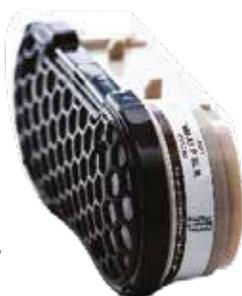
• Filtre ABE1P3 protège l'utilisateur des vapeurs ou gaz issus de matières organiques, inorganiques, acides et poussières. Ce filtre est très utilisé par les soudeurs lorsque les pièces à souder ne sont pas propres (reste de peinture, oxydation, graisse etc...). Certains procédés de soudage dégagent de l'ozone selon les configurations, ce filtre protège également de l'ozone.
