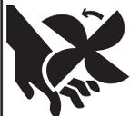
1.f. Ne pas mettre les mains près du ventilateur du moteur. Ne pas appuyer sur la tige de commande des gaz pendant que le moteur tourne.
