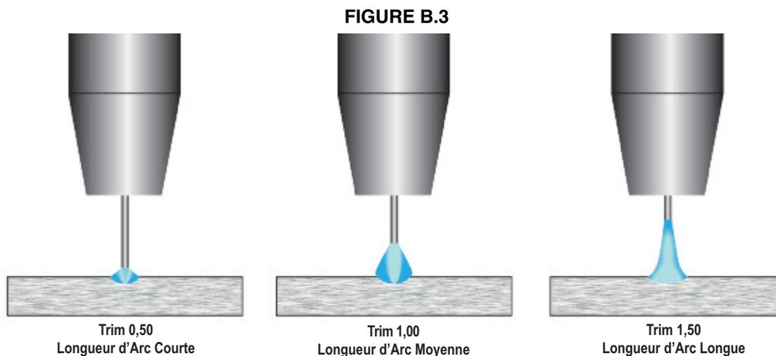
La plupart des programmes de soudage par impulsions sont synergiques. Lorsque la vitesse de dévidage est ajustée, la Power Wave® S500 recalcule automatiquement les paramètres de forme d'onde afin de maintenir des propriétés d'arc semblables.
