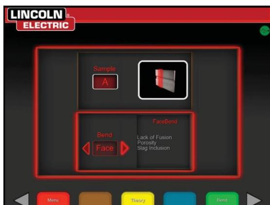
最初のサンプルが曲げられた後、「次へ」または「前へ」の白い矢印を使用して、曲げる次のタブを選択します。
