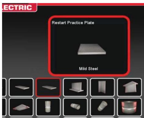
使用したいクーポンを選択した後、希望するプロセスを選択します(短絡GMAWまたは7018 SMAW)。通常のクーポン設置プロセスに従います。クーポンは小さな隙間がある部分的に溶接が完了したビードとして表示されます。受講者はいずれかの端を始点として選択し、再スタートして隙間を埋めます。
