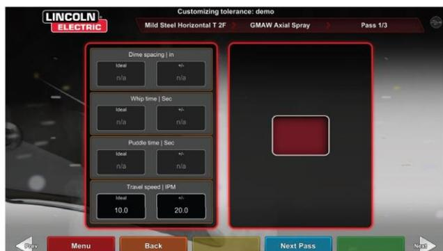
15. ウィーブ画面では、以下のようなウィービング溶接技術が変更できます(図85を参照してください)。
