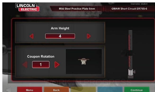
あらゆる仮想溶接の適用事例においてVRTEXが正しく動作するよう、正しいVRテーブル情報を選択する必要があります。図35を参照してください。テーブル設定情報を入力し、緑色の続行アイコンを選択すると、画面にポール設定および必要な接続されたデバイスのステータスが表示されます。緑色のチェックマークは正しく接続されたデバイスを、赤の×印は切断されたデバイスを示します。図36および37を参
