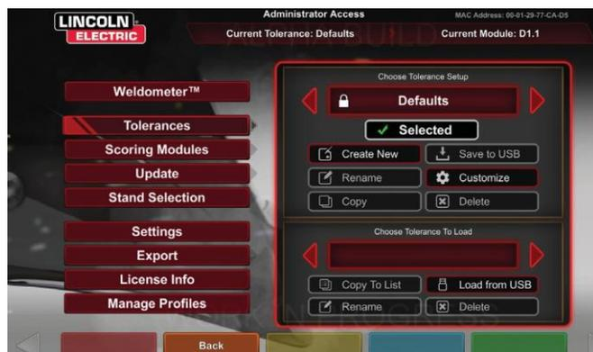
許容値エディタにより、「Choose Tolerance Setup(許容値設定の選択)」ウィンドウで現在表示されているファイルを変更します。
