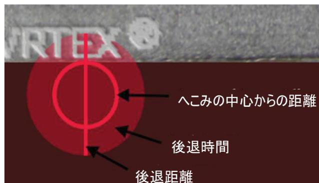
溶接デバイスが始点に近づくと、円が表示されます。円形のキューの色は、へこみの中心から始点までの距離を示しています。赤は制御範囲外であることを示し、LASERチャートには赤い採点用の四角形が表示されます。緑色の円は、始点が許容範囲内にあることを示します。
