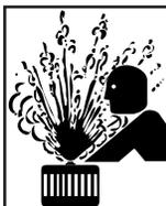
1.h. Pour éviter de s'ébouillanter, ne pas enlever le bouchon sous pression du radiateur quand le moteur est chaud.
