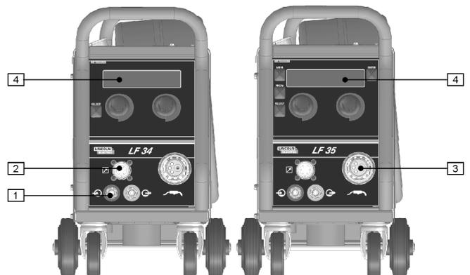
1. Connecteurs eau: Connexions pour les torches refroidies par eau.
