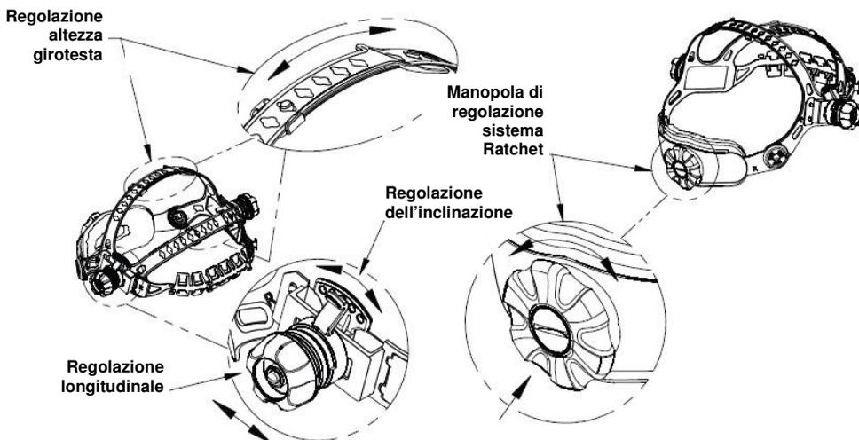
**REGOLAZIONE DEL GIRO TESTA:** IL GIROTESTA si regola premendo la manopola del sistema Ratchet e ruotandola per regolarla in base alle dimensioni della testa. Questa manopola è posizionata sul retro del casco. **LE REGOLAZIONI DELLA CORONA** vengono effettuate regolando il comfort e innestando i perni nel foro in modo da bloccarli in posizione.
