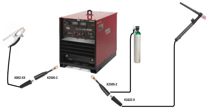
Figura 6 Conexión de antorchas de cable de 1 pieza enfriadas por aire, a fuentes de poder con terminal de salida tipo tornillo de 7 a 13mm, con paso del gas por separado
