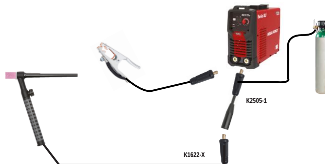
Figura 12 Conexión de antorchas de cable de 1 pieza enfriadas por aire, a fuentes de poder con terminal de salida Twist Mate (Dinse), con paso del gas por separado
