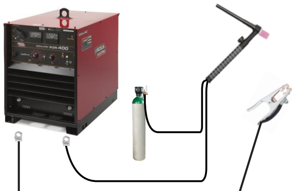
Figura 4 Conexión de antorchas de cable de 2 piezas enfriadas por aire, a fuentes de poder con terminal de salida tipo tornillo de 7 a 13mm, con paso del gas por separado
