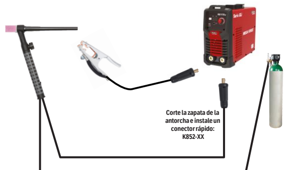
Figura 5 Conexión de antorchas de cable de 2 piezas enfriadas por aire, a fuentes de poder con terminal de salida Twist Mate (Dinse), con paso del gas por separado
