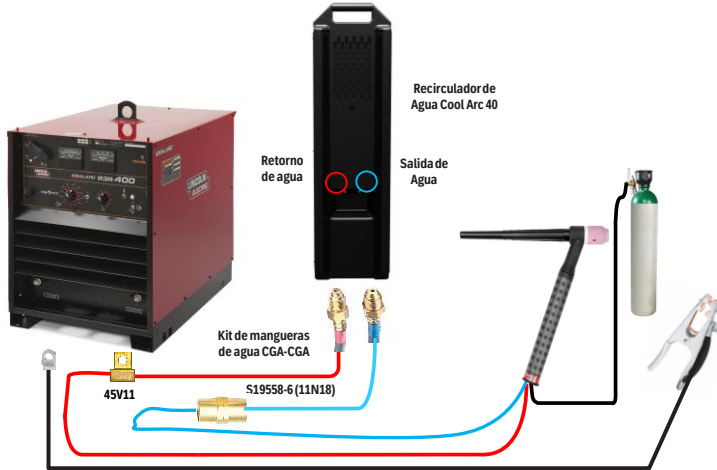
Figura 10 Conexión de antorchas enfriadas por agua, a fuentes de poder con terminal de salida Twist Mate (Dinse 13mm), con paso de gas por separado
