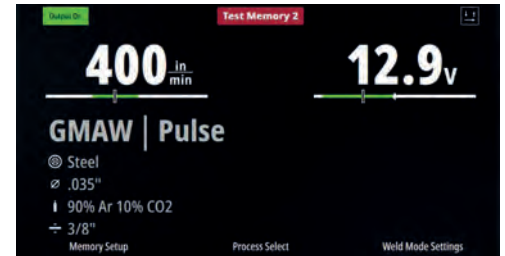
POWER MIG 262P - Pantalla de inicio con configuración guiada
