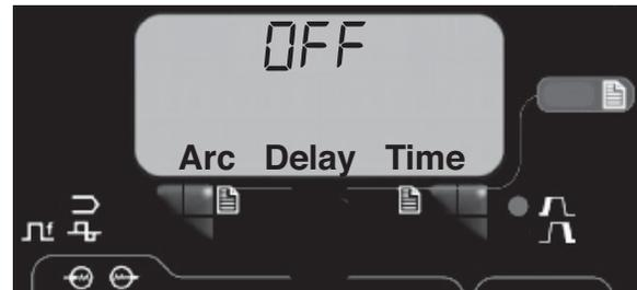
Utilice el Control de Panel de Selección de Modo para seleccionar el tiempo de demora deseado. Oprima el Selector de Modo de Soldadura para salir de los parámetros de Inicio.
