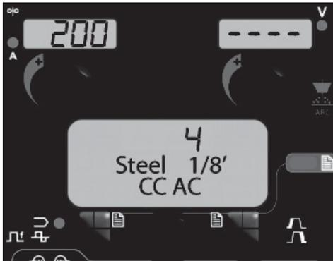
NOTA: Los modos CC mostrarán AMPS en la pantalla superior izquierda. Los modos CV mostrarán la velocidad de alimentación de alambre y el indicador WFS estará iluminado.
