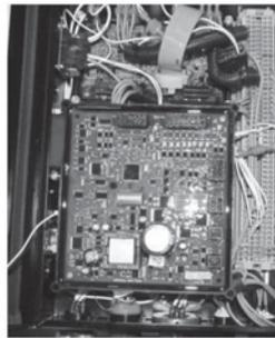
6- Reconecte el conector J331 a J88 en la tarjeta S30221-[] (G6752-[] ); después reconecte el resto de los conectores.
