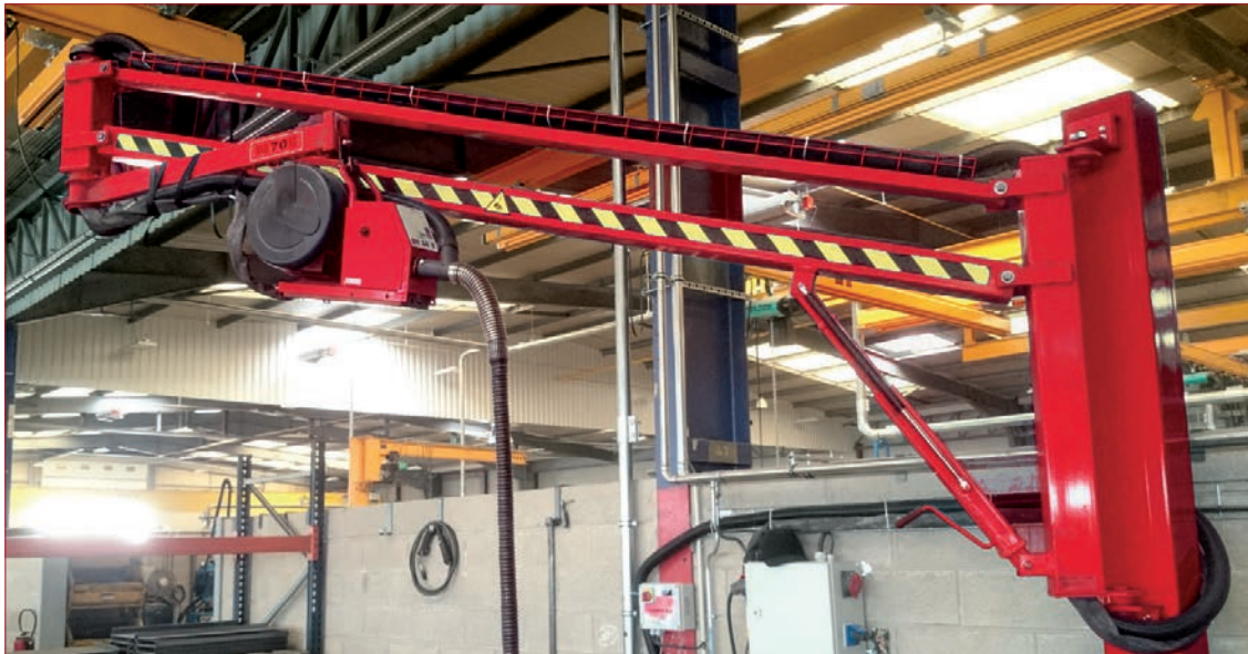
Potence Aëromig 3D 30-10 - Commande manivelle et cric compensé
