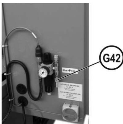
Collegare il tubo aria compressa sul filtro situato sul lato del cofano elettrico in rif G42.
