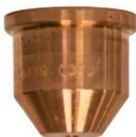
**La tuyère** est le consommable le plus fréquemment remplacé. L'un des signes indiquant que la tuyère doit être remplacée est l'accumulation excessive de scories et l'angle du biseau apparaissant sur vos coupes. Sur la tuyère elle-même, vous constaterez qu'un orifice plus large ou un trou de forme irrégulière constitueront des signes d'usure excessive.
