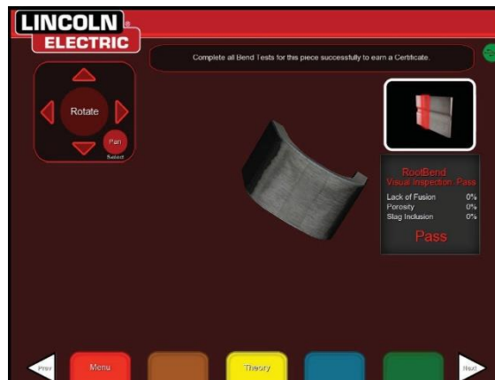
Figure 100 – Essai de pliage terminé
