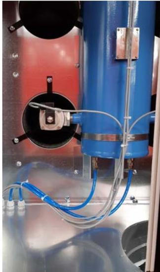
Il est important de contrôler le bon fonctionnement et le bon positionnement des électrovannes de décolmatage lors du remplacement des cartouches filtrantes.
