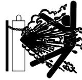
Si sufre algún daño, el CILINDRO puede explotar.
