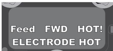
**ADVERTENCIA:** Esta función de “Alimentación en Caliente” habilita la salida de la fuente de poder y hay voltaje en el alambre mientras se alimenta hacia abajo. Evite tocar alguna parte expuesta como se define en las PRECAUCIONES DE SEGURIDAD.
