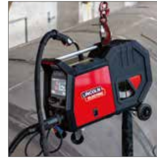
吊耳-起重悬挂 • 可垂直和悬浮操作 • 方便安全运输
