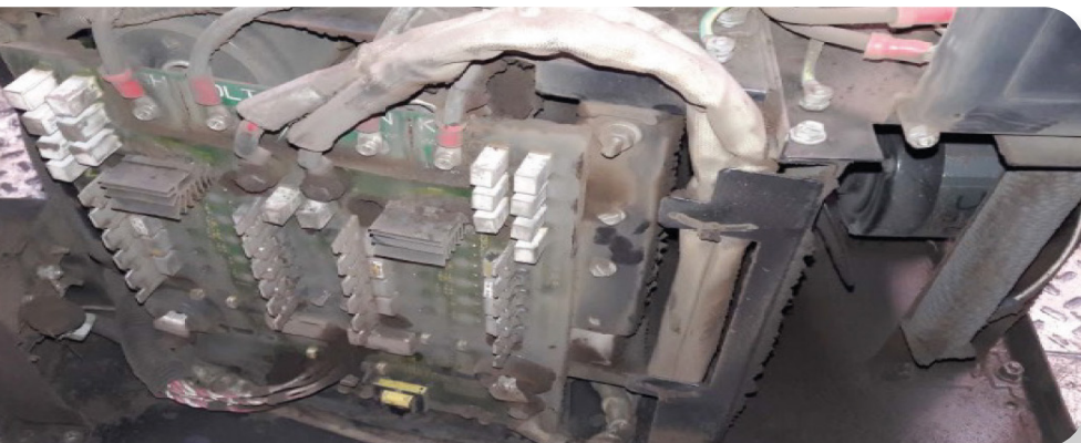
» Se aplica aire a presión después del aspirado para desincrustar el posible polvo que aún quede.
