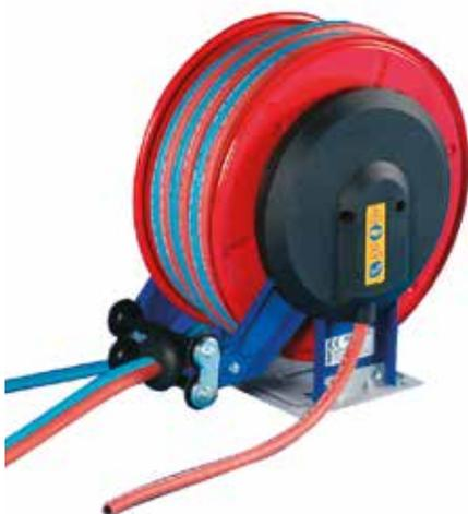
Enrouleur automatique de tuyaux jumelés Ø 8 ou 10 mm. Pour enrouler le tuyau, il suffit de le tirer de quelques centimètres afin de débloquer le cliquet et l'enrouleur enroulera automatiquement le tuyau.
