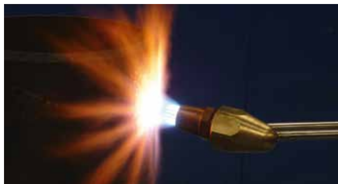
Chauffe avec buse multidard
