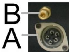
conectar la manguera al frente de ésta. A continuación, conecte una manguera entre el conector de gas en la parte posterior de la máquina y el regulador de gas instalado en el cilindro del gas empleado. La máquina incluye una manguera para la entrada de gas y los accesorios necesarios. Conecte el cable del gatillo de la antorcha al conector (A) ubicado en el frente de la máquina.
