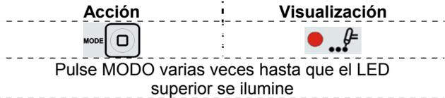
Este modo de soldadura se utiliza principalmente para realizar soldaduras provisionarias o sobre materiales finos. El arco arranca con alta frecuencia y la corriente de soldadura se establece inmediatamente sin pendientes ascendente y descendente. El tiempo de soldadura se puede controlar mediante el gatillo o ajustando el tiempo de punto.
