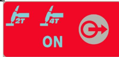
Dieser Abschnitt ermöglicht es dem Bediener, das gewünschte Verfahren für die Ausgangssteuerung einzustellen.
