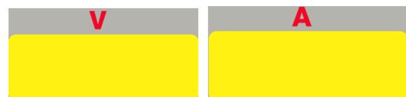
Rechts wird der voreingestellte Schweißstrom (A) vor dem Schweißen und der tatsächliche Schweißstrom während des Schweißens angezeigt und links die Spannung (V) an den Ausgangsleitungen.
