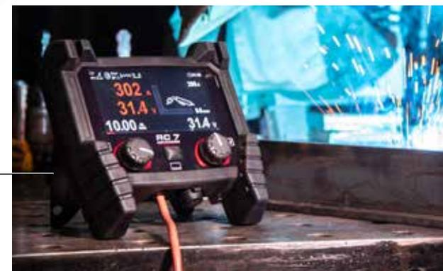
Supporto per sostenere il dispositivo su una superficie piana per esempio un banco di saldatura.
