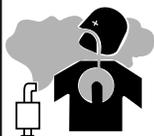
1.c. No cargar combustible cerca de un arco de soldadura cuando el motor esté funcionando. Apagar el motor y dejar que se enfríe antes de rellenar de combustible para impedir que el combustible derramado se vaporice al quedar en contacto con las piezas del motor caliente. No derramar combustible al llenar el tanque. Si se derrama, limpiarlo con un trapo y no arrancar el motor hasta que los vapores se hayan eliminado.
