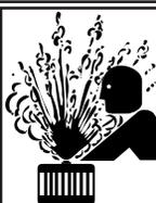
1.h. Para evitar quemarse con agua caliente, no quitar la tapa a presión del radiador mientras el motor está caliente.
