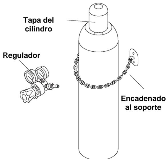
2. Retire la tapa del cilindro. Inspeccione las válvulas del cilindro y el regulador para ver si hay roscas dañadas, suciedad, polvo, aceite o grasa. Quite el polvo y la suciedad con un trapo limpio. **¡NO CONECTE EL REGULADOR SI HAY ACEITE, GRASA O DAÑOS!** Informe a su proveedor de gas de esta condición. El
