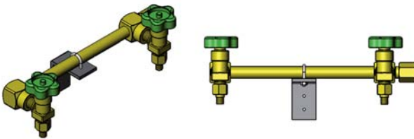
FIGURA 2. MONTAJE DE LAS VÁLVULAS DE SALIDA
