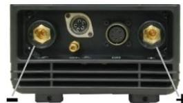
Para soldadura en polaridad CC(-) intercambie las conexiones en la máquina, de manera que el cable de pinza esté conectado al zócalo de salida (-) y el cable de masa al zócalo de salida (+).
