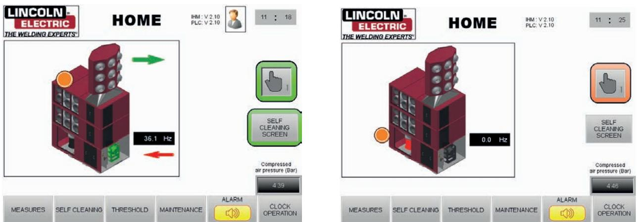
Visualisation par **un point orange** d'un dépassement des temps de maintenance :
