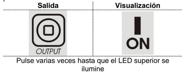
Cuando se selecciona la secuencia es posible iniciar una soldadura con el método de elevación (LIFT) sin apretar el gatillo.
