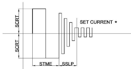
NOTA: los parámetros de ajuste almacenados aseguran el cebado del arco cuando el electrodo (diámetro y color) ha sido seleccionado correctamente.
