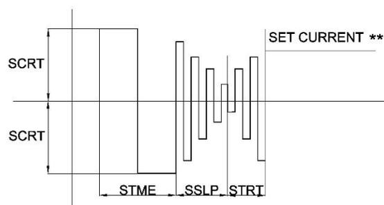
La secuencia de arranque también cambia si hay un pedal de control conectado: de hecho, considerando que el nivel STRT no se puede ajustar, el nivel al final de la pendiente SSLP es el nivel establecido por el pedal de control o el nivel PCRT.
