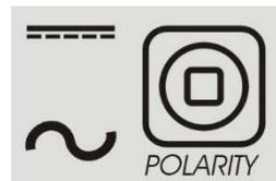
Este icono permite definir el tipo y la polaridad de la corriente del proceso de soldadura empleado: CC+, electrodo revestido en CA y TIG en CC y en CA.
