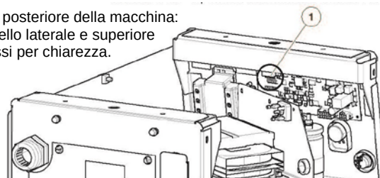
Figura 4: Posizione del dip switch sul PCB interfaccia utente.
