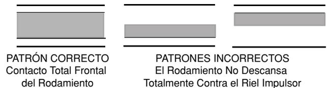
FIGURA A.9 CALZAS DEL RODAMIENTO
