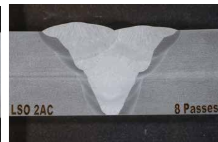
Sudare tandem AC LSO (grosime 40mm)
