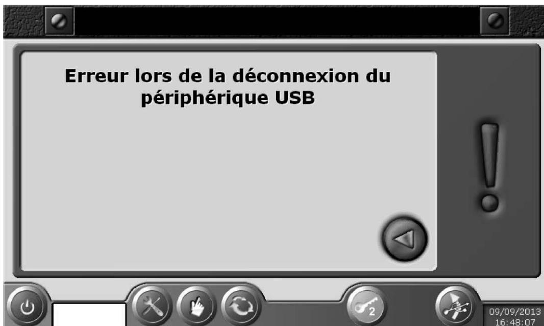
La déconnexion d'un support USB rend inactifs automatiquement les boutons qui en dépendent.
