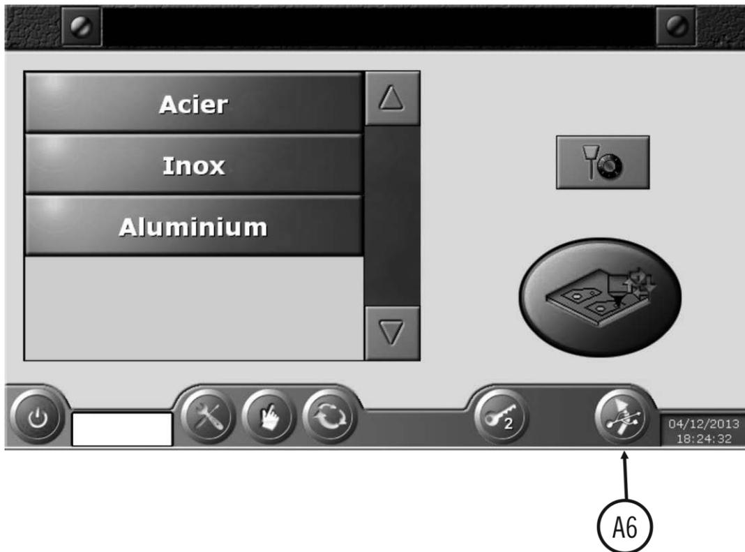
Le bouton de déconnexion d'un périphérique de stockage USB (bouton A6) est actif uniquement si un périphérique est connecté. Il est important de l'utiliser avant la déconnexion physique du périphérique afin d'éviter une potentielle perte de données.
