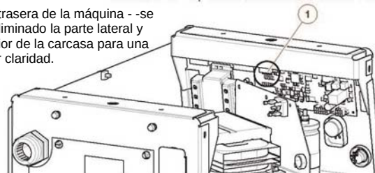
Figura 4: Ubicación del interruptor Dip en la interfaz de usuario PCB.
