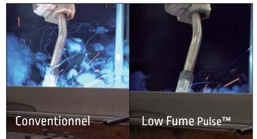
\* Réduction des émanations de fumée de 66 % (grammes/minute) avec un fil de 1,32 mm à 10 mètres par minute – même gaz, diamètre de fil, vitesse d'amenée de fil, distance tube contact/surface.
