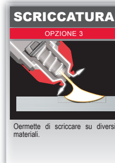
Spaccato torcia LC105 con ugello a contatto
