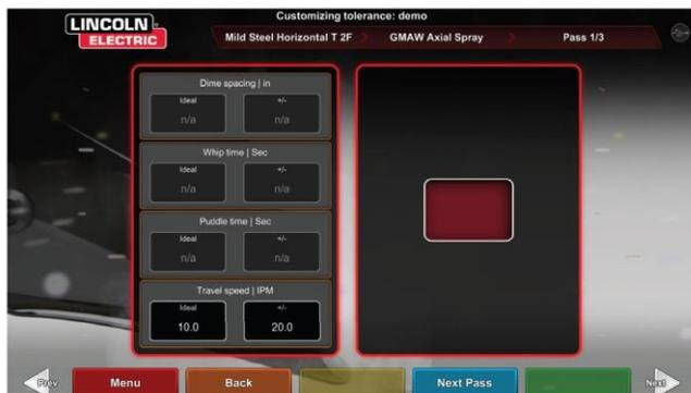
15. Экран поперечных колебаний позволяет изменять технологию сварки с поперечными колебаниями, включая (см. **Рисунок 85**):
