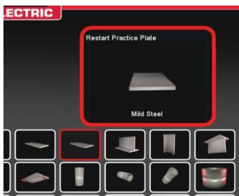
После выбора желаемого образца выберите желаемый процесс (короткое замыкание, GMAW или 7018 SMAW). Следуйте обычным процедурам настройки образца. Образец будет выглядеть как частично завершенный сварной шов с небольшим зазором. Для возобновления и заполнения зазора ученик может выбрать любой конец в качестве начальной точки.
