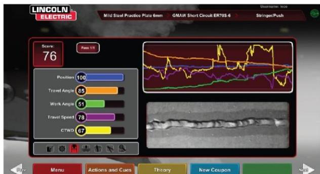
10. Выберите **New Coupon (Новый образец)**, чтобы продолжить работу в режиме байпаса, или **Change Coupon Type (Изменить тип образца)**, чтобы вернуться к экрану и выбрать **Exit Bypass Mode (Выход из режима байпаса)**.
