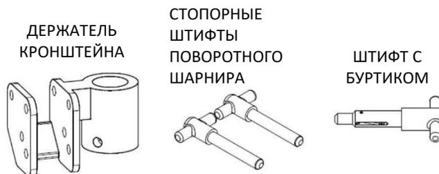
18. Установите держатель кронштейна, поместив его над стойкой и сдвинув вниз на высоту чуть выше желаемой. Частично вставьте штифт с буртиком в соответствующее отверстие. Одновременно с этим переместите держатель кронштейна вниз, вставляя штифт до тех пор, пока держатель кронштейна не упрется в штифт, а кончик штифта не войдет в держатель кронштейна через отверстие. См. **Рис. 20**.
