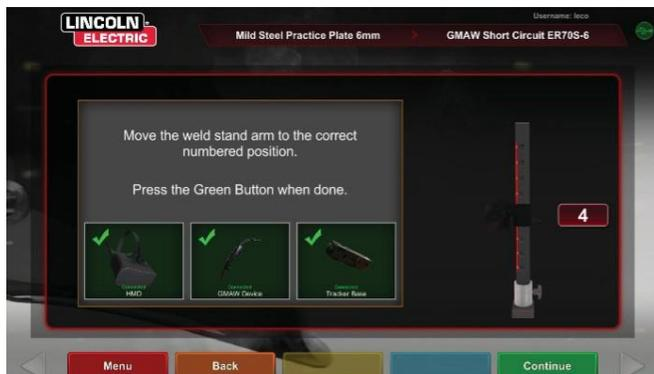
8. При нажатии зеленого значка «Продолжить» пользователь минует экраны настроек машины и перейдет непосредственно к сварке. См. **Рисунок 67**. После завершения сварки выберите **End Pass (Завершить проход)**, чтобы получить оценку.
