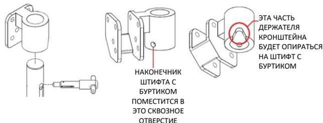
19. «**КОНСОЛЬ ОБРАЗЦА**» – Извлеките содержимое из коробки. Снимите нейлоновую кабельную стяжку, крепящую кабель к консоли. Установите консоль образца в держатель кронштейна, используя два стопорных штифта поворотного шарнира. См. **рисунки 21 и 22**.
