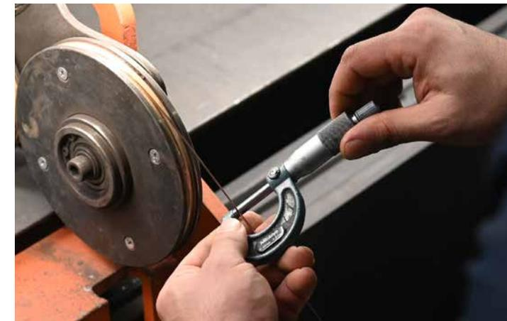
Le diamètre et la forme du fil sont régulièrement vérifiés pour garantir la stabilité de l'arc.
