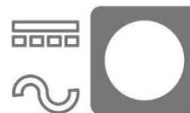
Über dieses Symbol wird die Polarität des verwendeten Verfahrens geregelt: DC+, AC Elektrode, DC- & AC WIG-Verfahren.
