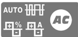
Mit diesen Symbolen kann der Bediener die Lichtbogenleistung beim WIG-Schweißen nur in Wechselstrom-Polarität einstellen.
