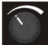
Der Steuerknopf für den Hauptstrom soll eine Schnellauswahl zur Anpassung der Hauptstrom-Einstellung ermöglichen. Mit dieser Funktion können Nutzer den Sequenzerbereich des U/I schnell verlassen, sodass es nicht mehr nötig ist, durch alle möglichen Sequenzfunktionen zu gehen, um die Hauptstromstärke einzustellen oder das Sequenzermenü zu verlassen.
