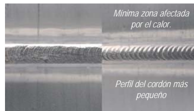
Soldadura con TIG estándar (a 60 amps)
