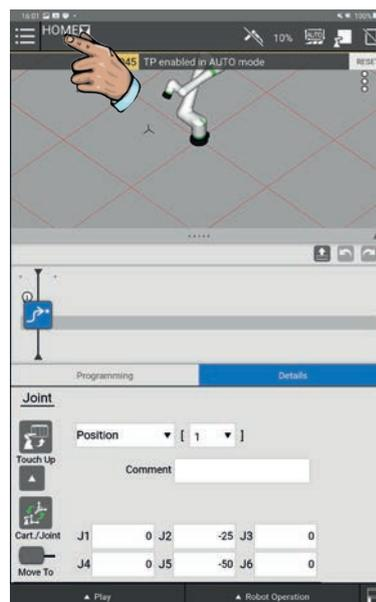
Passare in modalità manuale, premere il tasto **"FWD"** del campo **"Robot operation"** per spostare il robot verso la posizione **"HOME"**.
