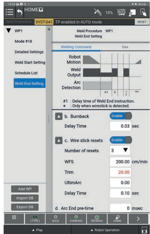
Spostare manualmente il robot nel punto di fine saldatura.
