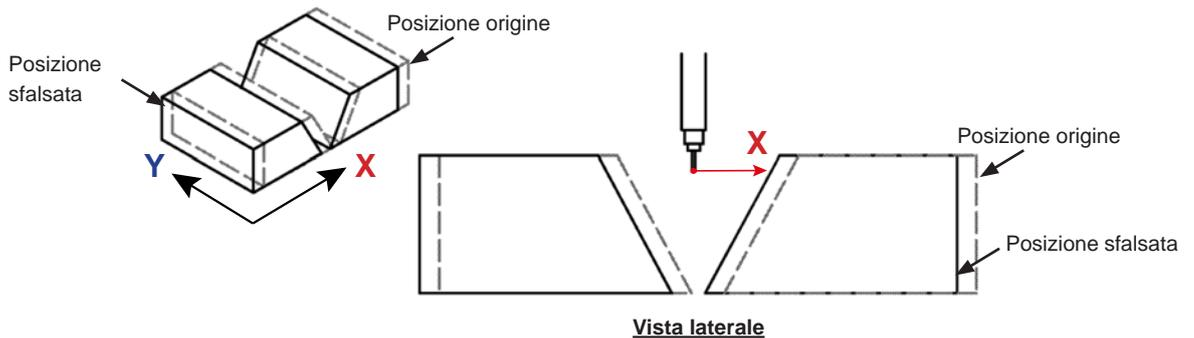
"Through Arc Seam Tracking" è una funzione software che permette di eseguire una tracciatura del giunto nell'arco di saldatura.
