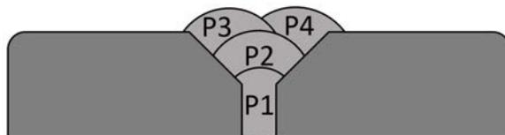
Gli offset di sfalsamento vengono impostati nel menu di saldatura, il che permette di cambiare per ogni passaggio la posizione della torcia, i parametri di saldatura e i parametri di scansione.
