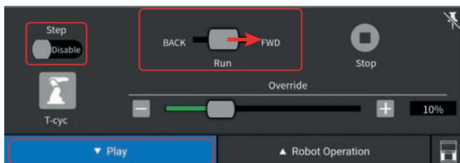
Mantenendo il cursore "Run" verso la posizione "FWD" si esegue il programma in ordine cronologico. Per eseguire il programma in senso anticronologico, mantenere il cursore "Run" nella posizione "BACK". Se il cursore "Step" è "Enable", significa che il robot si fermerà tra un punto e l'altro del programma. Se il cursore "Step" è "Disable", tutte le sequenze del programma si susseguiranno sino alla fine del programma o fino al rilascio del cursore "Run".
