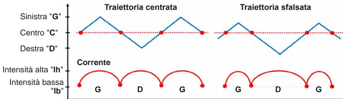
Il "TAST" offre una correzione per i giunti di saldatura imperfetti, ma richiede una configurazione minuziosa delle variabili del sistema e richiede una comprensione approfondita del processo di saldatura.
