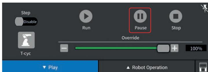
Al termine del programma di produzione, il robot si arresta nell'ultima posizione registrata nel programma eseguito. Idealmente, si consiglia di terminare un programma con la posizione "**Home**".
