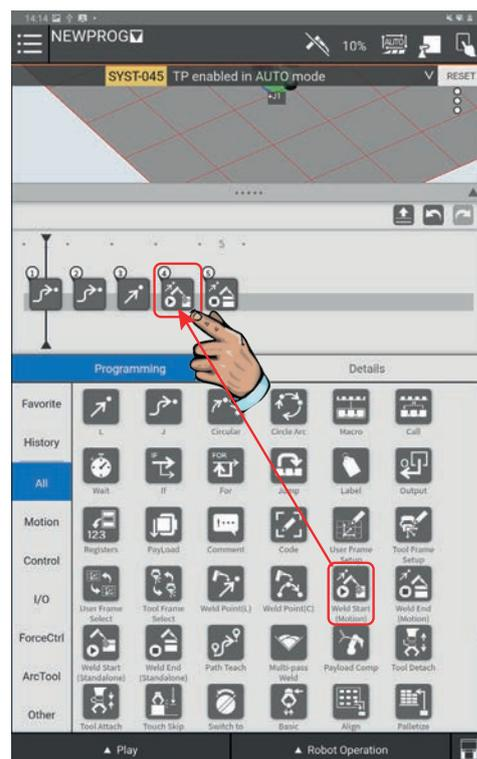
Premere l'icona **"Weld Start (Motion)"**, poi selezionare la scheda **"Weld Start"** per inserire la **"Weld Procedure"** e il **"Weld Schedule"** desiderato a partire dai menu a scorrimento.
