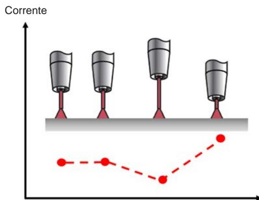
Inoltre, il "TAST" utilizza la funzione di scansione del robot per determinare la posizione laterale della torcia nel giunto di saldatura.
