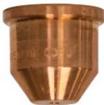
**Die Düse** ist das am häufigsten ausgewechselte Verbrauchsteil. Eins der Zeichen, dass die Düse ausgewechselt werden muss, ist die übermäßige Ansammlung von Schlacke und der Winkel der Kanten an Ihren Zuschnitten. An der Düse selbst lässt sich eine größere Öffnung bzw. ein unregelmäßig geformtes Loch feststellen, was Zeichen für einen übermäßigen Verschleiß ist.
