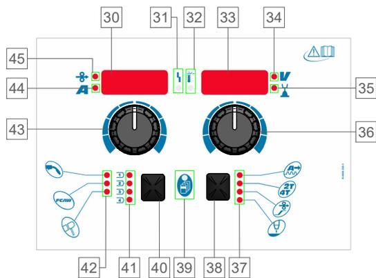
30. Левый дисплей: Показывает скорость подачи проволоки или сварочный ток. Во время сварки показывает фактическое значение сварочного тока.
