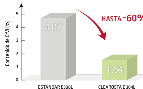
Concentración de CrVI – MMA CLEAROSTA E vs Estándar 308L
